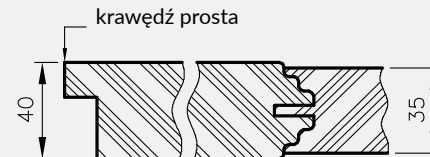
Przekrój poziomy drzwi Scala i Trevi
