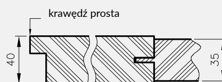
Przekrój poziomy drzwi Scala i Trevi
