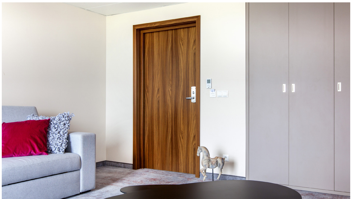
drzwi EI60 PLUS, ościeżnica drewniana regulowana
