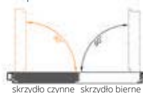
B. Drzwi prawe otwierane do wewnątrz
