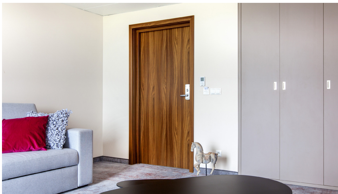
drzwi EI60 PLUS, ościeżnica drewniana regulowana
